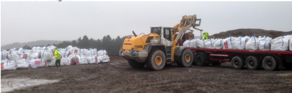
Asbesthaltige Baustoffe in Big Bags, Entladung auf der Deponie Eberstetten mit dem Radlader und der montierten Ladegabel
